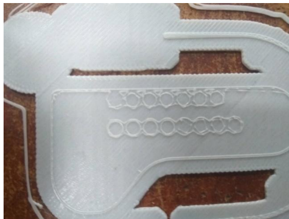
Kẹt nhựa do chọn Retraction Distance lớn.
