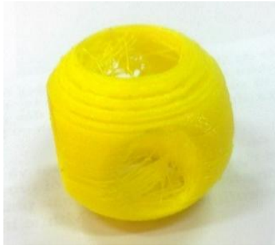
Hình 31: Mẫu sản phẩm bị lỗi nhựa không đều
