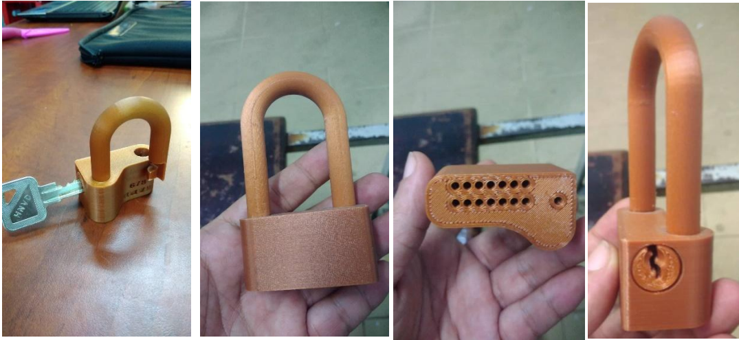
Hình 17: Ổ khóa được sản xuất từ công nghệ in 3D.
