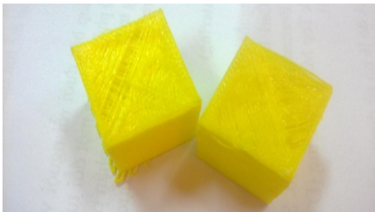
Hình 36: Mẫu sản phẩm bị chảy xệ
